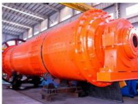
原料磨 RAW MATERIAL MILL
