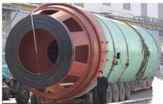
水泥磨 CEMENT MILL
